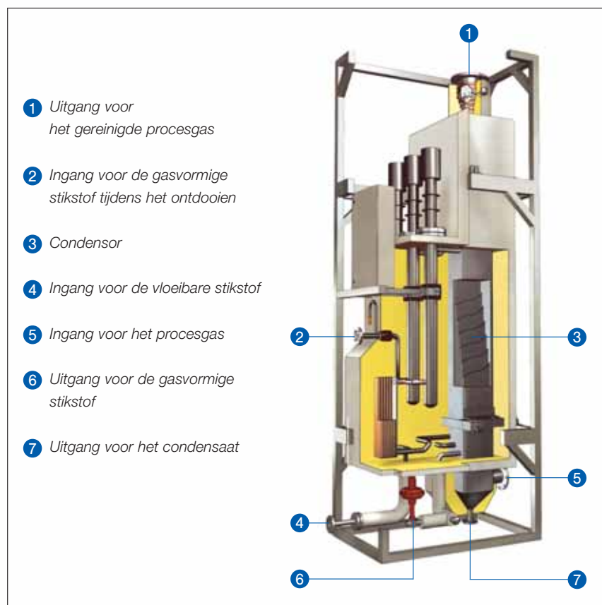
Principeschema van de werking van de Cirrus-technologie.
